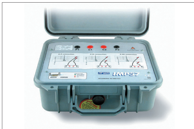
Fot. 2 Przystawka IMP57 do pomiarów pętli zwarciowej z rozdzielczością 0,1 mΩ w instalacjach przemysłowych
