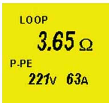
Rys. 5. Przykład ekranu miernika podczas pomiaru dużym prądem impedancji pętli przewód fazowy-przewód ochronny
