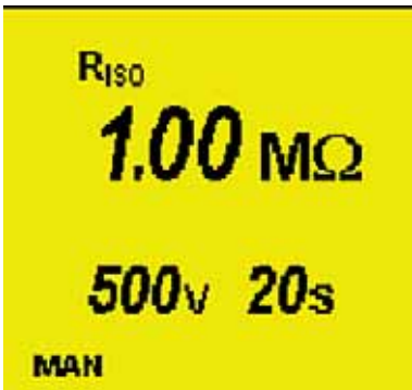
Rys. 3. Przykład ekranu miernika podczas pomiaru rezystancji izolacji w trybie ręcznym
